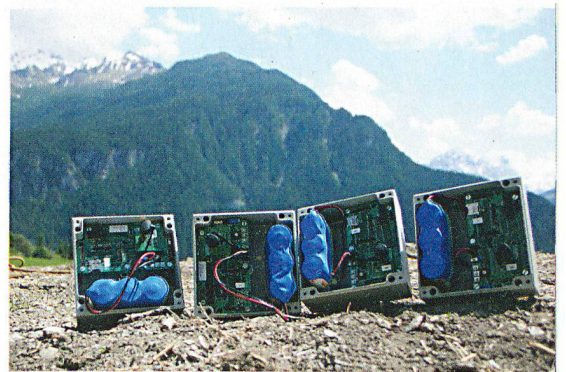
Die RockNet-Sensoren – hier vor der Montage – messen Erschütterungen im Gelände.
