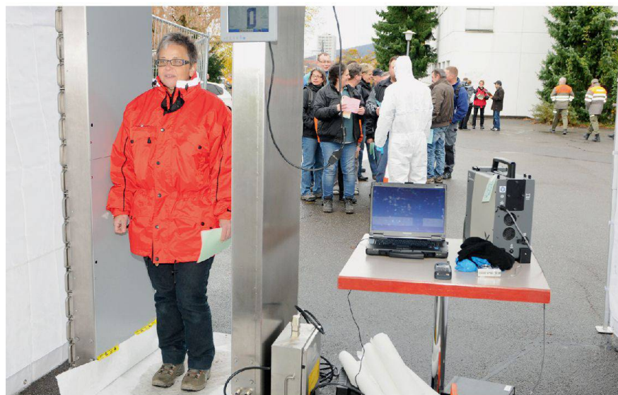
Beratungsstelle Radioaktivität im Betrieb: Zutritt durch Portalmonitor.
