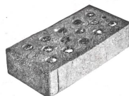
Der Normalstein im Format 25/12/6 cm kann als der klassische Backstein bezeichnet werden, denn er wurde schon vor Jahrtausenden hergestellt, allerdings ohne Lochung.
