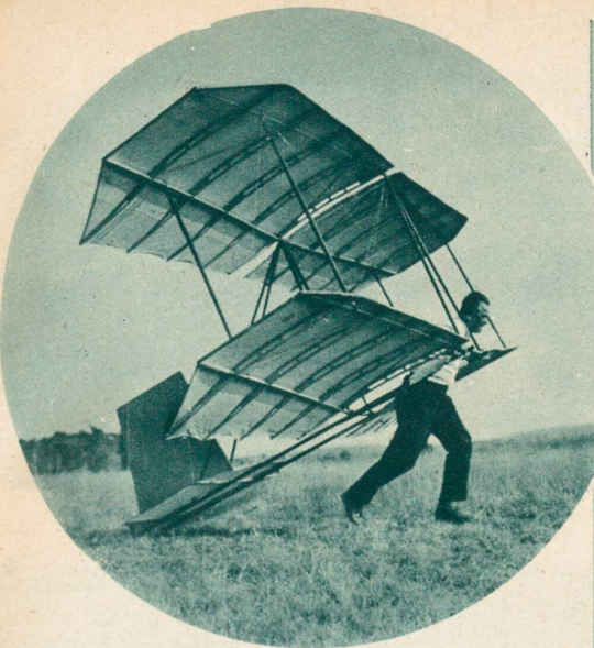
Segelfluggpionier Hans Richter mit seinem Volks - Segelflugzeug. Verkaufspreis zirka 220 Fr., Spannweite 5 Meter, Gewicht 14 Kg. Der Aufstieg geschieht durch bloßen Anlauf gegen den Wind. — Nun wird an schönen Sonntagen bald alles in der Luft herumfliegen. Phot. Keystone.
