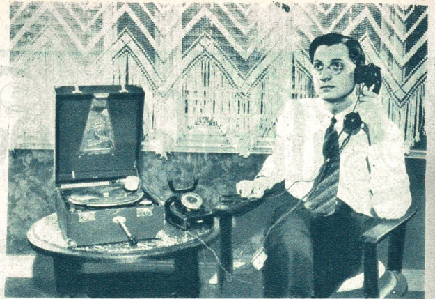
Das Telefongespräch auf der Schallplatte. H. Dillge, Mitarbeiter des Erfinders mit dem neuerfundnen »Teleskriptor«, der jedes Telefongespräch, Rede und Gegenrede, mittels eines Verstärkers und einer Aufnahmevorrichtung auf kleine unzerbrechliche Schallplatten festhält. Man legt den »Teleskriptor« mittels eines Bügels über den Kopf und hält den Telephonhörer statt an das Ohr an die Muschel des Geräts. Photo Wide World, Berlin.
