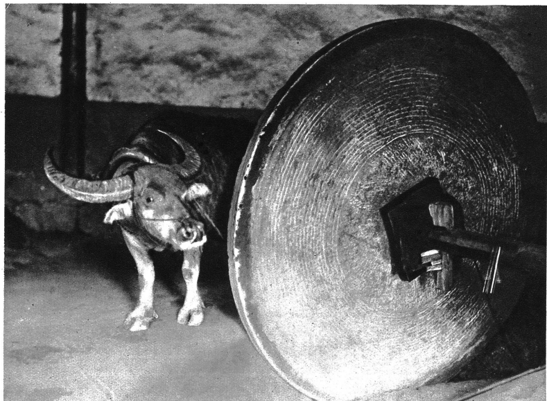
Noch heute wird in den Zinkbergwerken Chinas m. solch primitiven Mühlsteinen, von einem Ochsen getrieben, das Mineral aus dem Gestein gewonnen.
