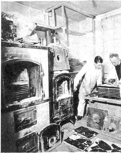
Die Gussplatten werden in den Muffelöfen eingelegt. Der Ofen wird zuerst vorgewärmt.
