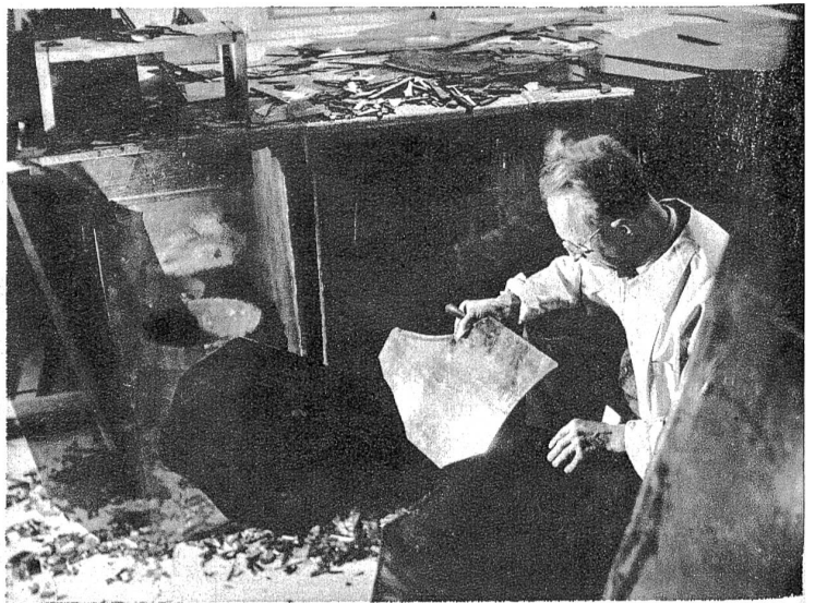
Etwas vom Wichtigsten ist die Auswahl des Glases. Es muss in Farbe und Glanz der Vorlage entsprechen und sich harmonisch in das Gesamtbild einfügen. Besonders bemerkenswert ist, dass die Farben bei durchstrahlendem Licht andere Werte aufweisen, wie in auffallendem. Einzelne Farben lassen mehr Licht durch als andere, sie „überstrahlen“. Dies muss bei der Komposition der Gemälde berücksichtigt werden.
