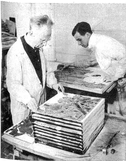
Die bemalten Gläser werden auf Gussplatten aufgelegt, die mit Kreidemehl bestreut sind, damit sich die Glasstücke beim Weichwerden im Ofen nicht festkleben.
