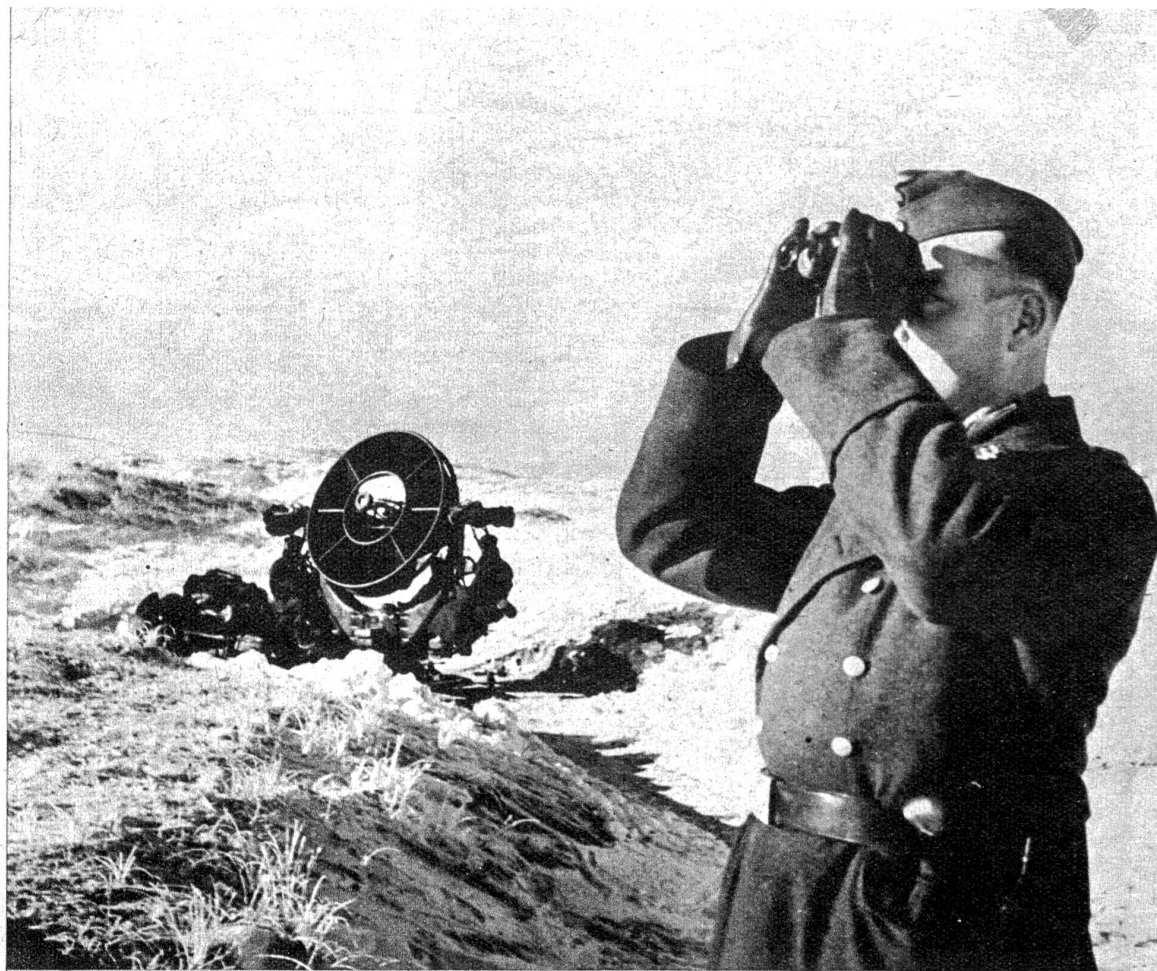
Das in den Sanddünen der Kanal- küste versteckte Horchgerät mel- det einen Flieger schon lange be- vor man ihn mit bloßem Auge erkennen kann. — Ist es Freund oder Feind?
