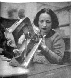
Jede Schraube muss nachkontrolliert und wenn nötig nachgezogen werden.
