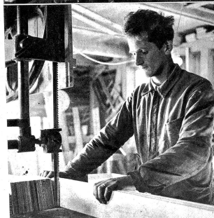
Aus Sperrholzlatten wird das Holzstück für die Boden und Deckel der Schachteln gesägt
