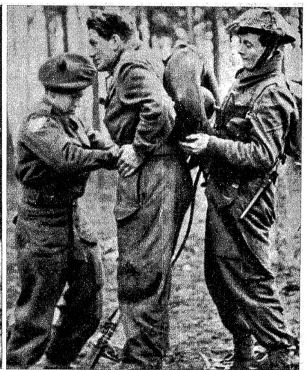
Links: Flammenwerfer in Aktion. Rechts: An der Westfront gelangen neue britische Flammenwerfer zum Einsatz. Auf dem Rücken der Soldaten ist ein Ringschlauch angebracht, in dessen Mitte sich noch ein zweiter Behälter befindet. Beide enthalten komprimierte Gase, welche in das gewehrlaufartige Rohr eingeführt werden und beim Austritt oxidieren. Die verheerende Wirkung erzeugender Flammen haben eine Reichweite von nahezu 50 Metern.
