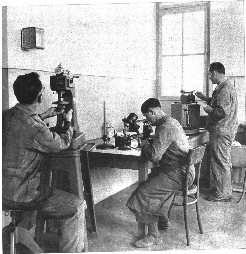
Elektrischer Warmluftofen zum Anlassen von Uhrenfedernbändern bei einer Temperatur von zirka 200 Grad Celsius. Rechts: Das elektrische Schweißen von Uhrenfedernbändern muss derselben Genauigkeit unterworfen werden, dass nur mit Zuhilfenahme von Lupen der Vorgang richtig durchgeführt werden kann
