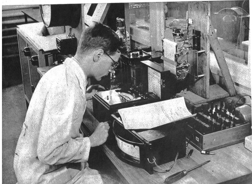
Ein Mengemesser für alle Medien wird geeicht
