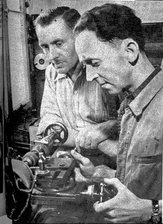
Vor dem Versand wird eine genaue mikroskopische Kontrolle der fertigen Steine vorgenommen
