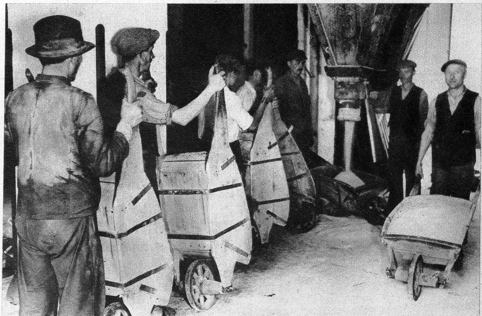
Vermag das Förderband nicht alle Arbeit zu leisten, so wird feingemahltes Steinsalz auch im Schubkarren gefasst und zur Verschiffung gerollt — Links: In der Salzkapelle: Steinsalzfiguren, darstellend die heilige Kunigunde und den heiligen Antonius
