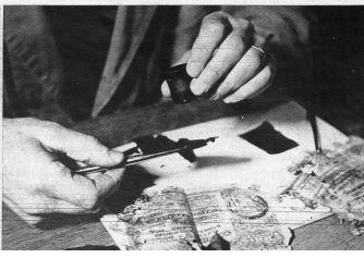
Pinzette, Lupe und diverse Flüssigkeiten helfen dem Fachmann, irgendwelche Erkennungszeichen stark defekter oder verkolter Noten zu finden (Photos Tschirren)
