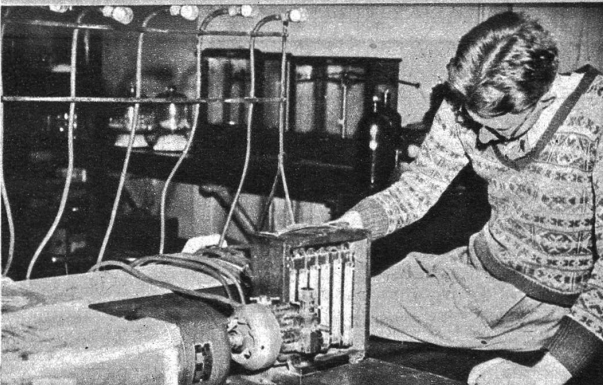
Oben: Mit derartigen Instrumenten werden Luftströmungen und Staubgehalt in Fabriken und Bergwerken analysiert. Unten: Sollte das zur Prüfung gelangende Objekt auch nur die geringste Menge von Arsenik enthalten, das abgebildete Gerät wird es dem Chemiker verraten
