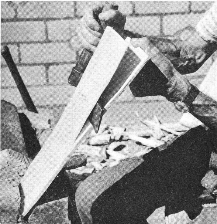
In raschen schwingenden Bewegungen stößt der Schindelmacher das Schindelmesser durch den Mösel.
