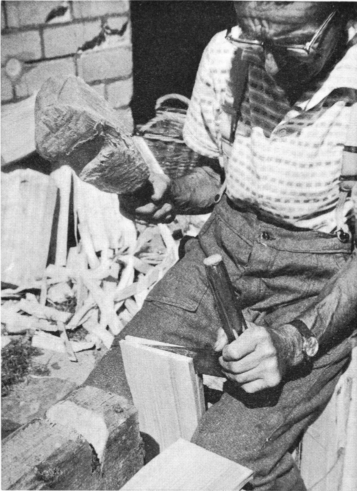
Der Schindler spaltet die geteilte Müsela mit dem Schindeleisen und dem Holzpoppel.
