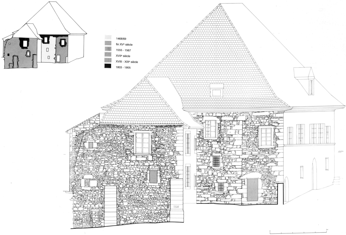
Fig. 22 Estavayer-le-Lac/Maison Griset de Forel. Relevé des façades sud-ouest avec indication des phases (1:100)
