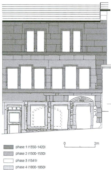
Fig. 12 Fribourg/Place du Petit-Saint-Jean 9. Relevé de la façade avec les phases de construction
