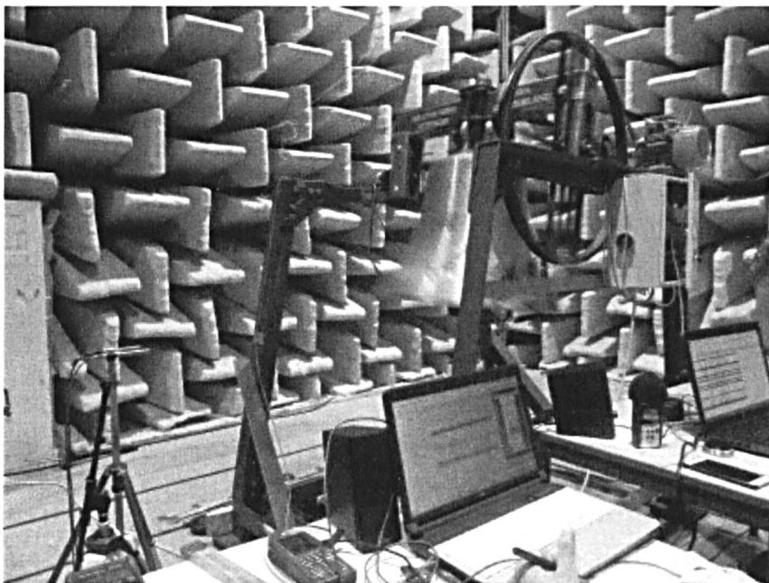
Abb. 4: Läutemessung an einer Glocke mit verkörpftem Joch im Schalllabor
