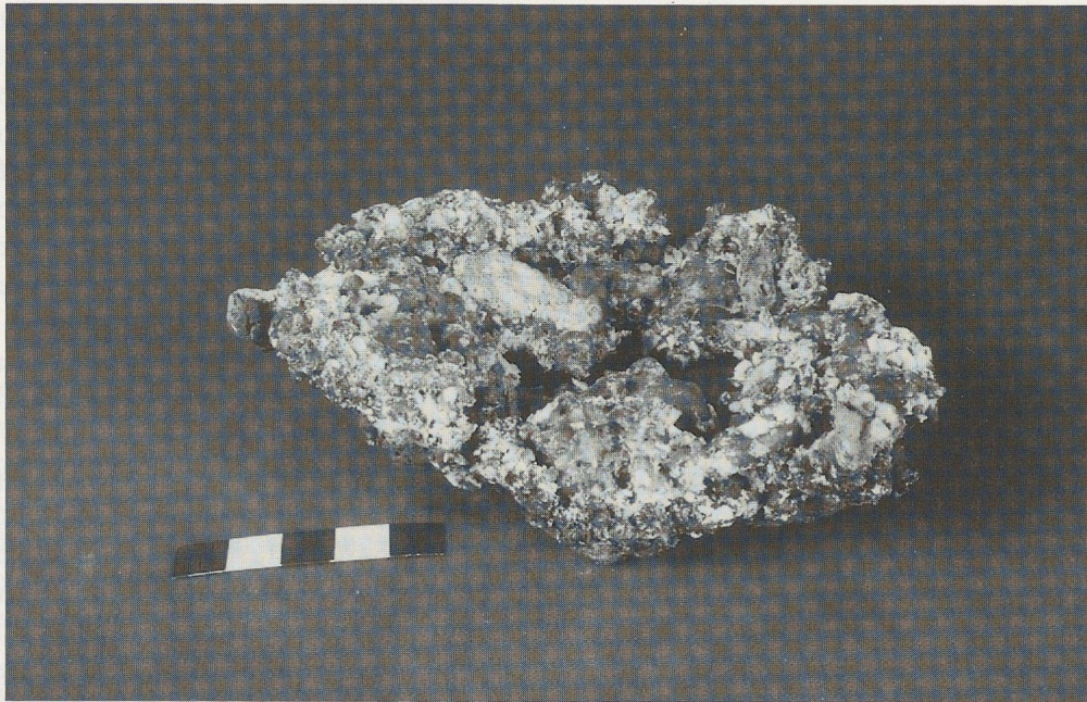
Fig. 28 Croûte de mâchefer de forme concave provenant d'un foyer de forge moderne - Musée du Fer de Vallorbe (Photo IAHA).
