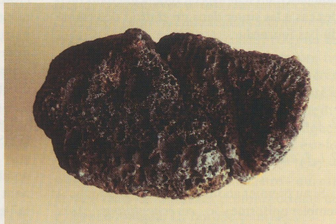
Fig. 31 Scorie ayant coulé sur une surface plane et provenant du bas-fourneau IIb - échantillon n° 7 (Photos IAHA).
