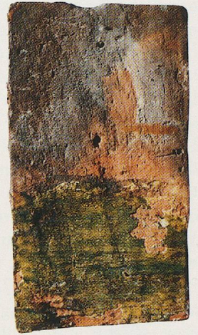
Fig. 65a-b. Tuiles trouvées sur la tour-lanterne de la Cathédrale de Lausanne et décorées d'un vernis vert foncé sans engobe (a) ou vert sur engobe clair (b).
