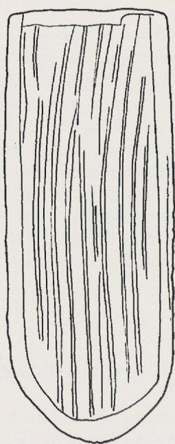
Fig. 92. Cas particulier de tuile dont la découpe ogivale est de forme presque arrondie (Avenches, Tour de Montauban).
