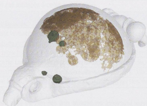
fig. 132 Bracelet en alliage cuivreux (cat. 276). Vue semi-transparente d'une tomographie aux neutrons. En vert, quatre sphères métalliques et en brun-jaune une matière non définie. Document réalisé par le laboratoire Neutron Imaging and Activation, Paul Scherrer Institut, Villigen (AG).
