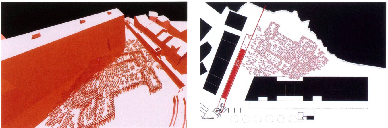
Fig. 190 – Le projet prévoyait une restitution tridimensionnelle du tracé et des profils des vestiges, sur le principe du conformateur des archéologues, au moyen de pilotis émergeant à différentes hauteurs, évoquant un espace entre cimetière et espace ludique.
