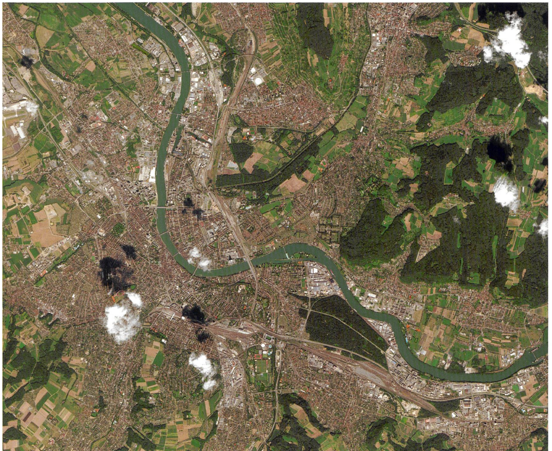
Abb.1: Pleiades-1 Aufnahme über der Region Basel vom 22. August 2016. Der Auftrag zur Aufnahme wurde am Vortag ausgelöst. Die Aufnahme des Perimeters (>300 km 2 ) mit 50 cm Auflösung konnte leider nicht komplett wolkenfrei erfolgen. (© 2016 Airbus)
