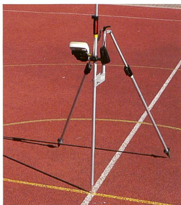
Abb. 2: Ob rot, ob grün, ob blau: Hochpräzise landesweite Passpunktmessungen (nicht nur auf Sportanlagen) bilden den geometrischen Anker orientierter Satelliten- und Luftbildprodukte von swisstopo.
