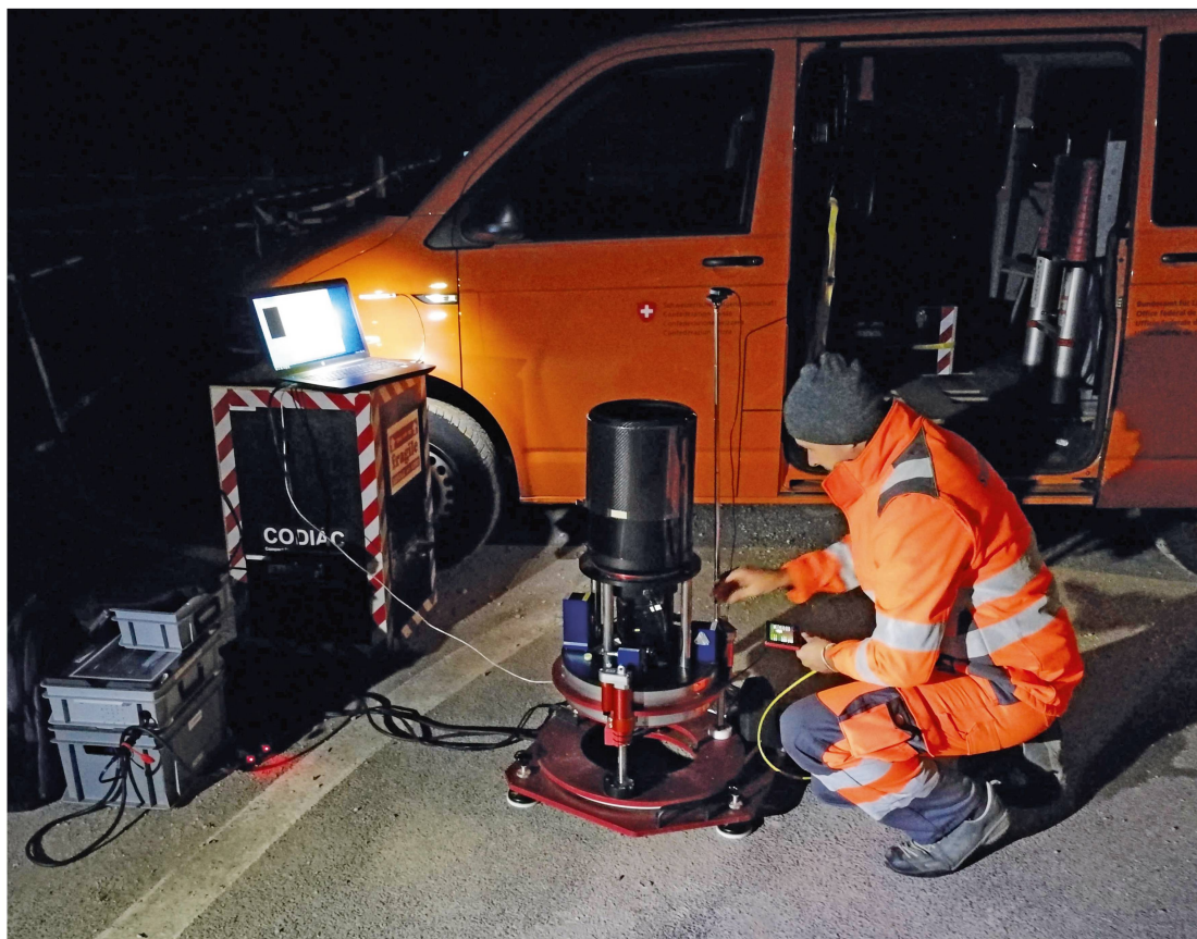
Abb.: Lotabweichungsmessung mit der digitalen Zenitkamera CODIAC
