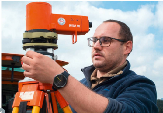
Abbildung 4: Zentrierung mittels Nadirlot. Die Zentrierung stellt sicher, dass sich der Messaufbau genau über dem Fixpunkt befindet.
