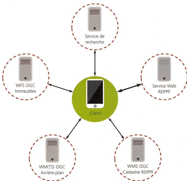
Figure 3: schéma de l'architecture système de l'extrait intelligent
