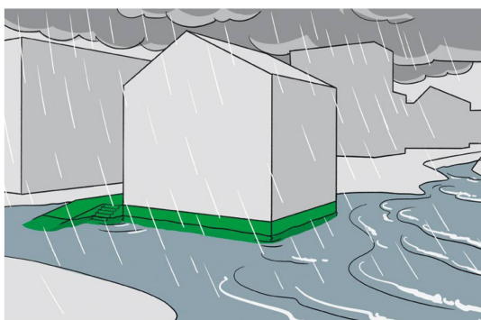
Figure 1: surélever les nouvelles constructions constitue le moyen le plus simple et le plus efficace de les protéger contre les crues et le ruissellement de surface (Source: www.protection-dangers-naturels.ch )
