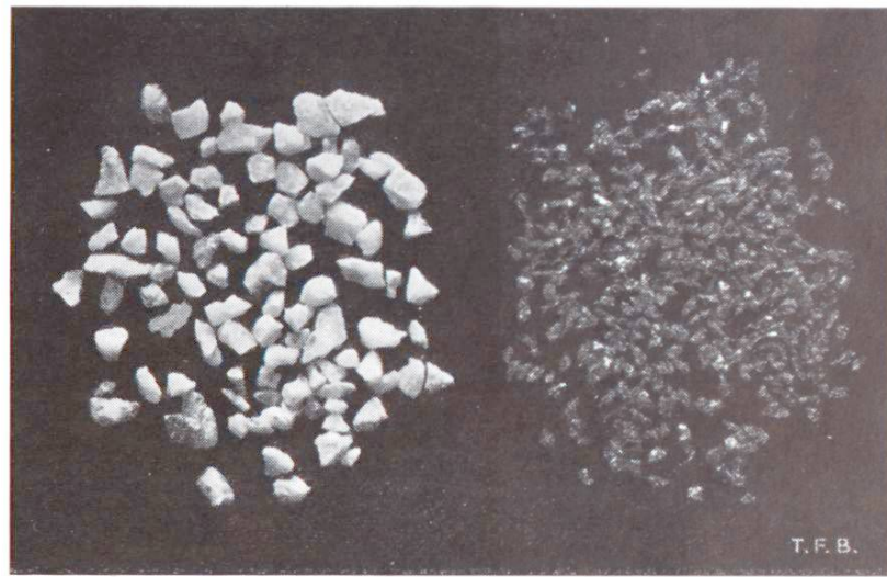
Abb. 4 Links Quarzit (natürliches Hartgestein), Härte 7, rechts Siliziumkarbid (künstliches Hartmaterial), Härte 9—10
