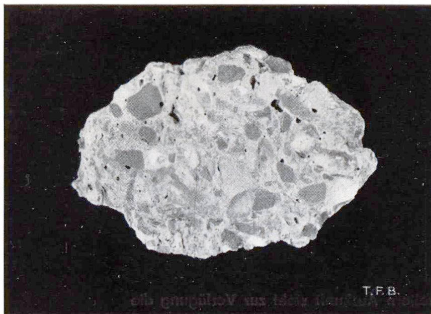
Abb. 2 Römischer Beton aus Wasserleitung in Avenches (Aventicum)
