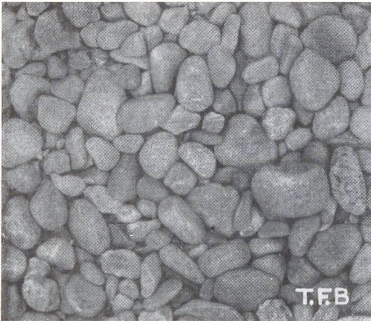
Abb. 1 Natürlicher Betonkies aus eiszeitlichem Terrassenschotter
