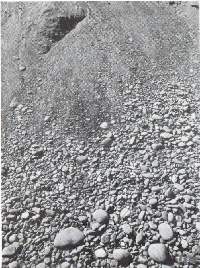
Abb. 1 Entmischung an einer Deponie von Sandkies
