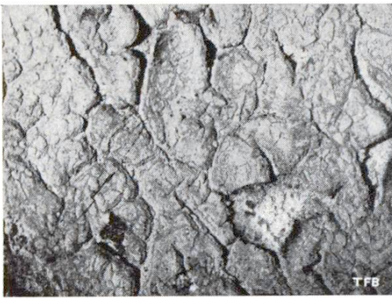
Abb. 4 Zersetzung eines Ölfarbanstrichs auf frischer, unbehandelter Cementunterlage
