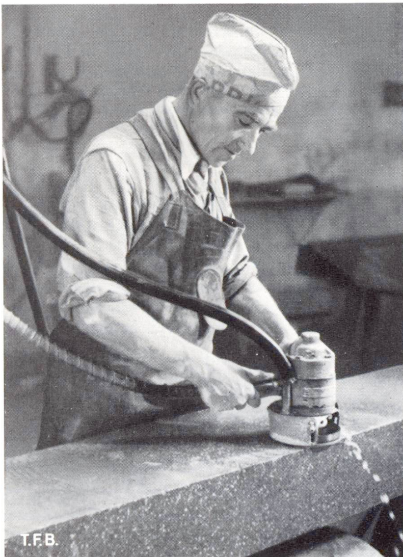
Abb. 2 Handschleifmaschine mit flexibler Welle und Wasserzuführung im Betrieb
