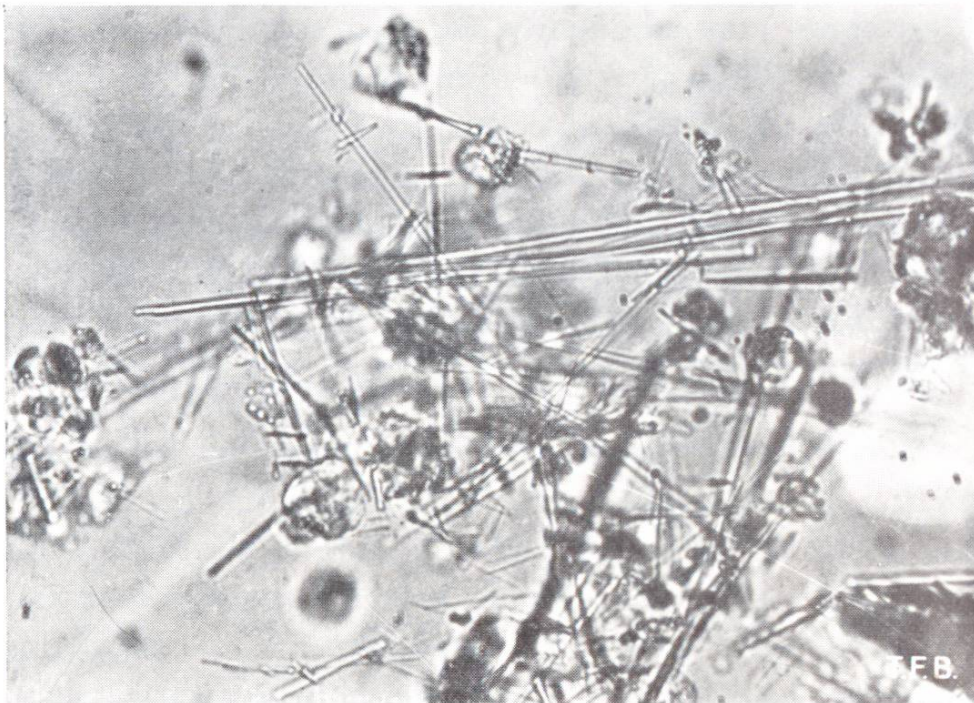
Abb. 5 Mikroskopisches Bild von langen Nadeln von Aluminaten, Sulfoaluminaten und Carboaluminaten, die sich nach 3jähriger Erhärtung der Cementminerale bildeten (Vergrößerung 580fach)
