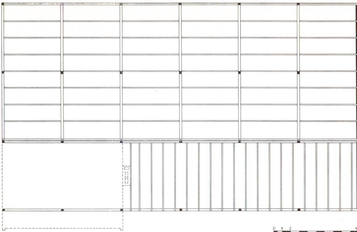
Abb. 2 Draufsicht auf grosses und kleines Pultdach, mit Bindersystem und Pfeften
