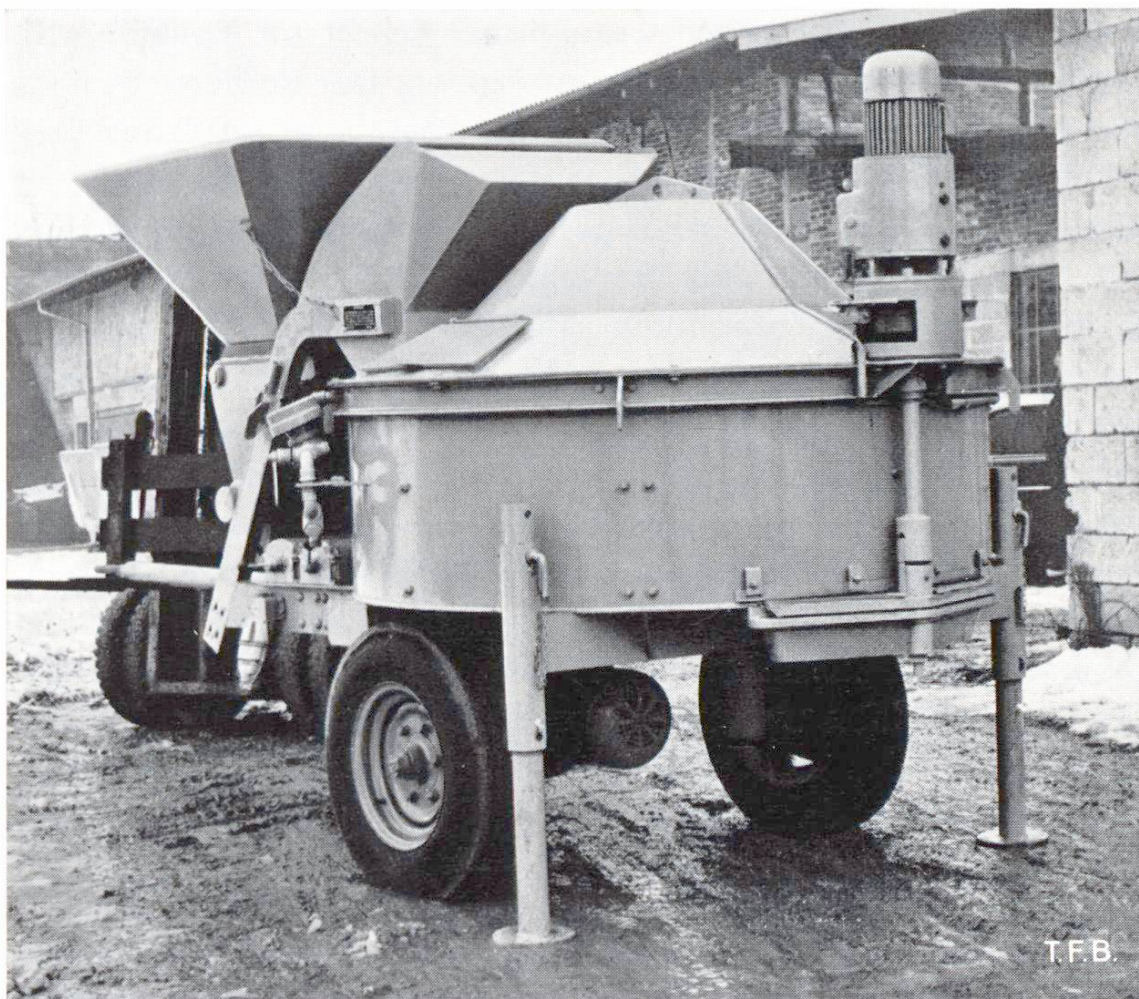
Abb. 2 Turbomischer mit Aufzugskübel und Einfülltrichter. Am Mischgefäß vorn erkennt man den mit einem besonderen Elektromotor betätigten Segmentschieber für die Entleerung
