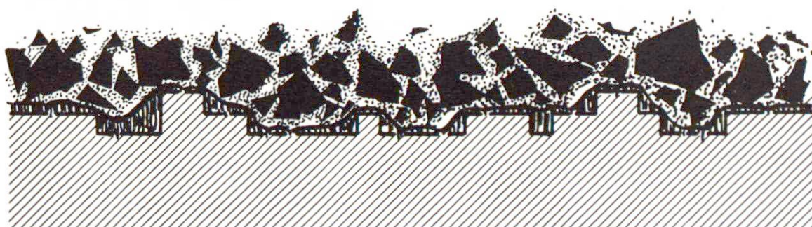
Abb. 3 Schematische Darstellung der Verhinderung der Haftung durch Auftrag einer meist fettigen Zwischenschicht.
