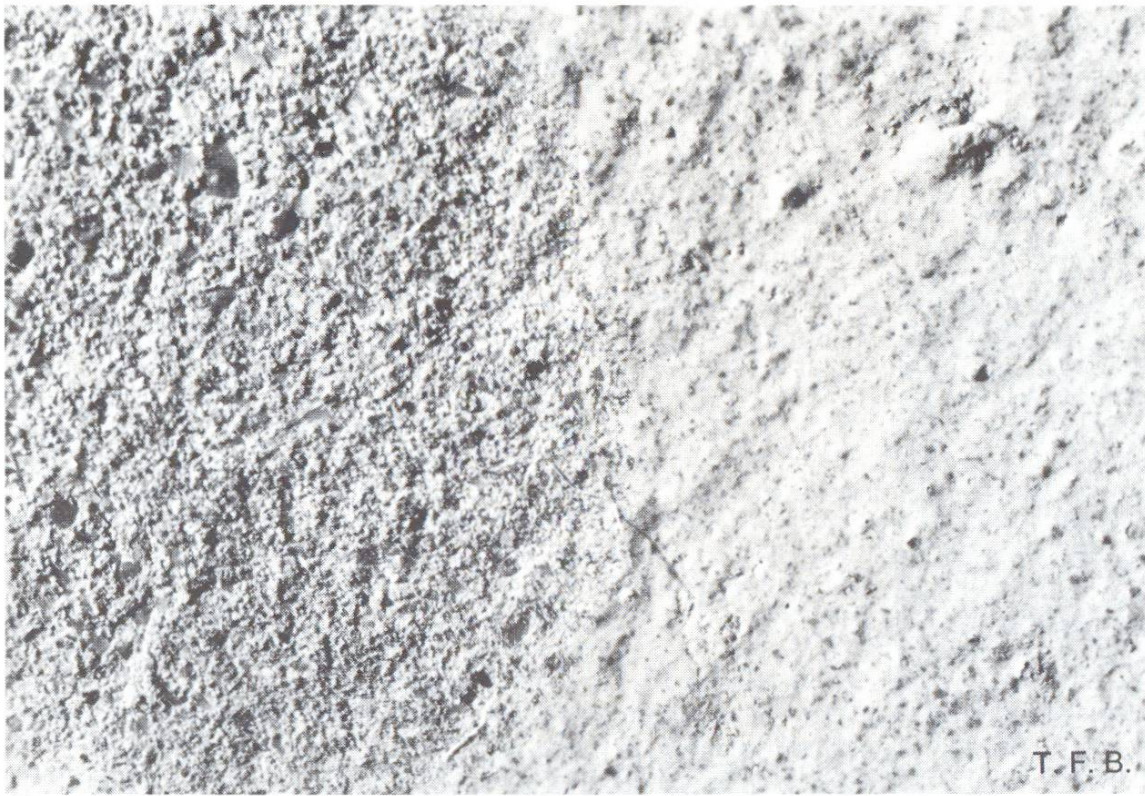
Abb. 2 Die rechte Bildseite zeigt eine fast vollständig geschlossene Schicht ausgeschiedenen Kalkes, der auf der rechten Seite mit Salzsäure aufgelöst worden ist. Man erkennt die Beiträge der verschiedenen Komponenten an die Grautönung. Auch die zahlreichen Unebenheiten zeigen Wirkung mit ihrem Licht- und Schattenspiel.
