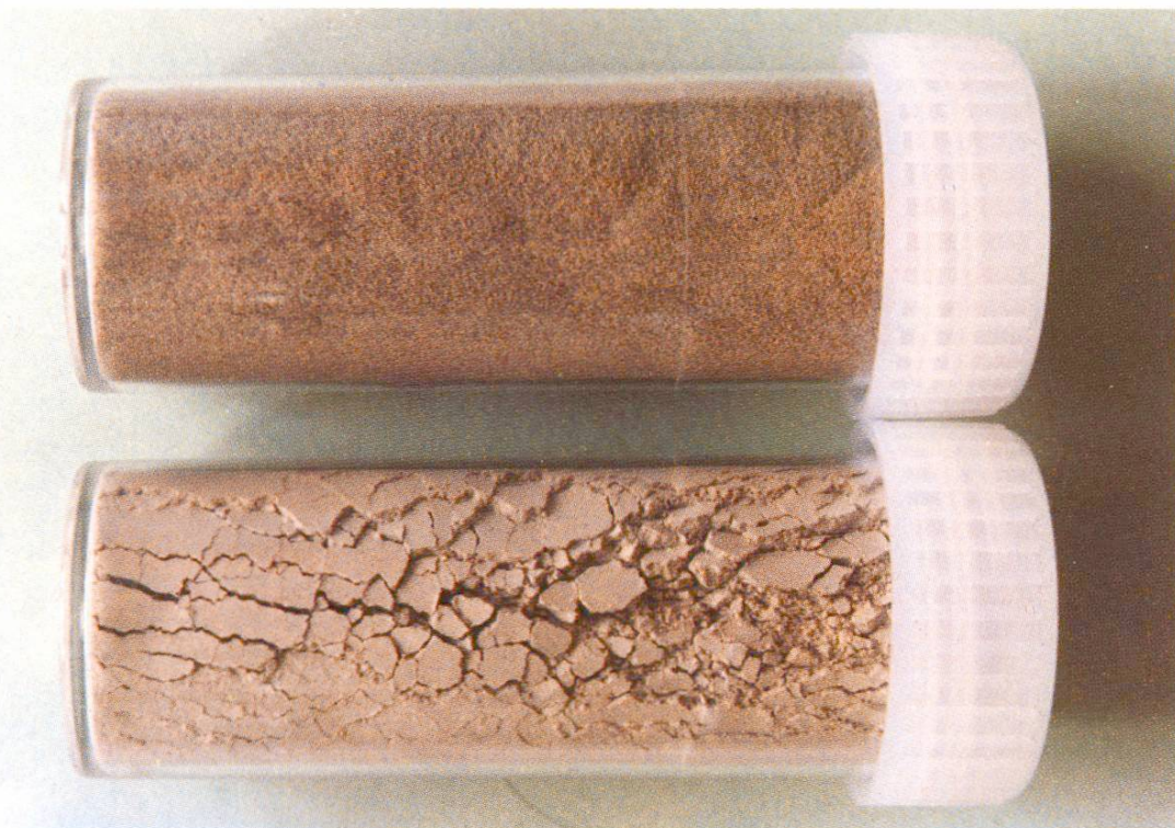
Abb. 2b Feinstanteil \varnothing < 0,1 mm von zwei verschiedenen Sanden. Die Probe im oberen Fläschchen ist körnig und «rollt» bzw. rinnt wie Sanduhrsand (Kurve A). Die Probe im unteren Fläschchen ist mehlfein und «bricht» (Kurve B).
