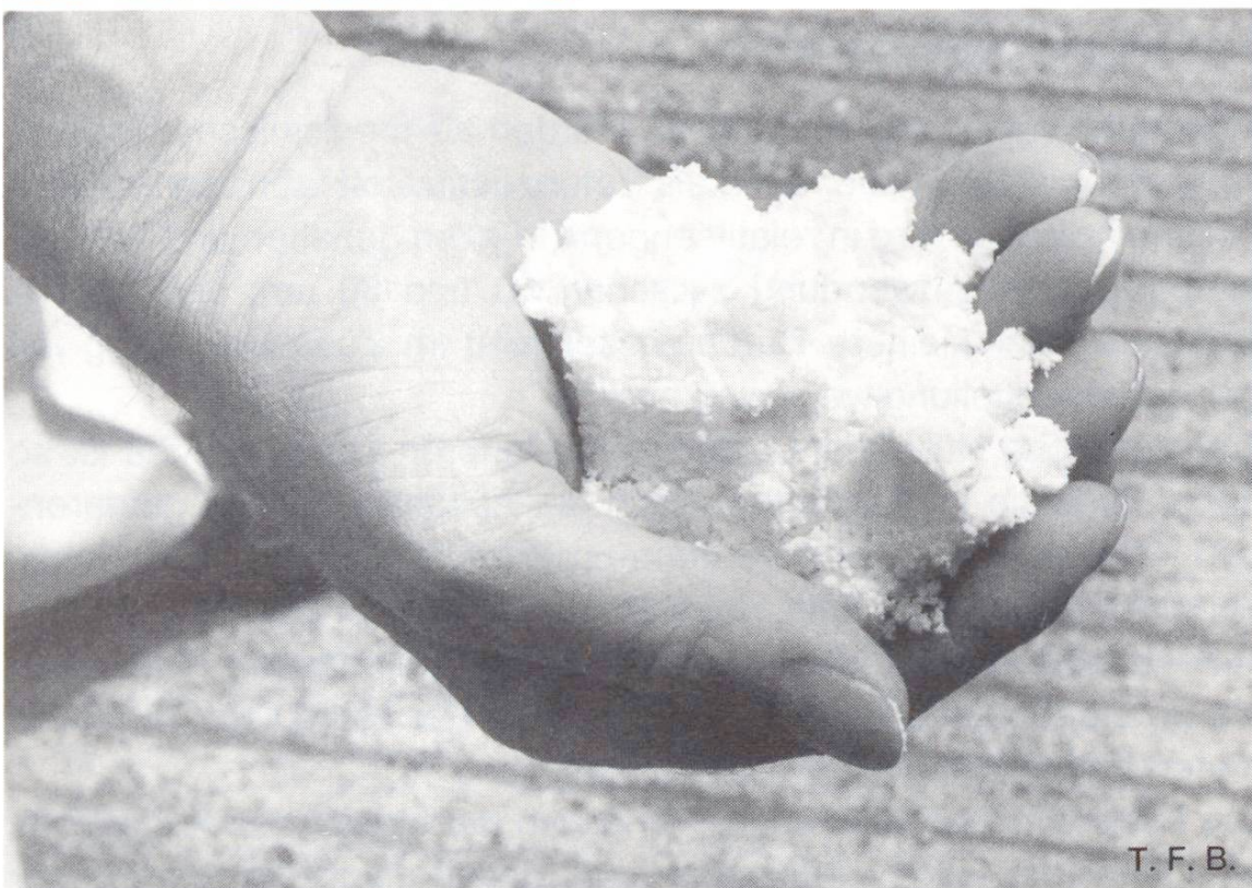
Abb. 2 MHK-Paste. Schüttdichte etwa 75 g/l.
