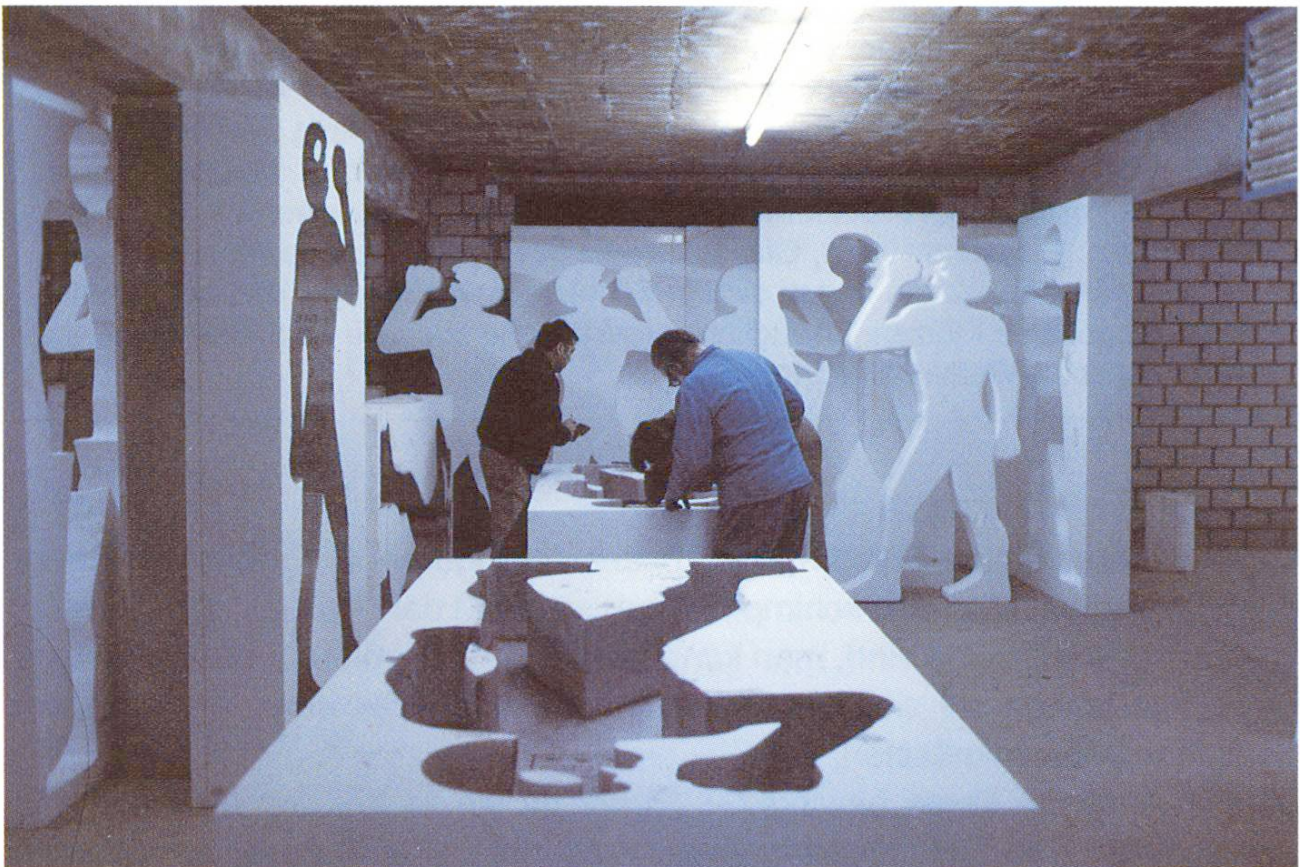
Schalung aus Schaumstoff. Arbeit am Negativ
