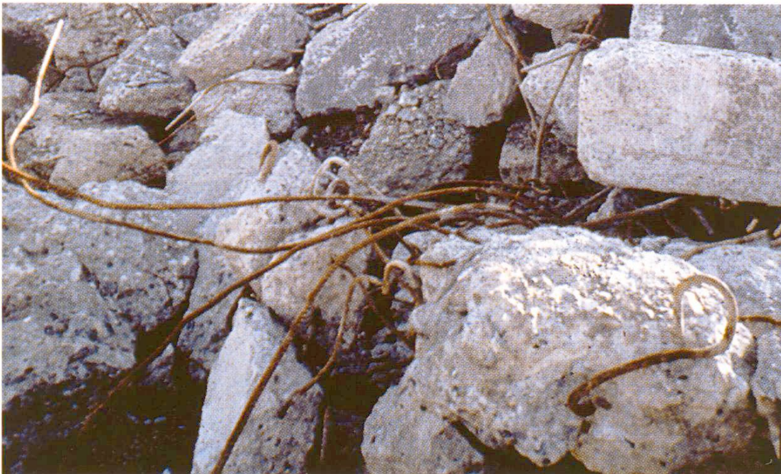
Netzbewehrter roher Betonstrassenabbruch, der nach geeigneter Aufarbeitung zu einem wertvollen Rohstoff beim Ausbau der N 13 im St.Galler Rheintal wurde. (Foto: Betonstrassen AG)
