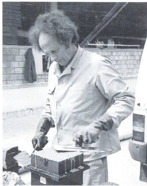
Abtalschieren der Oberfläche des fertig hergestellten Würfels.
