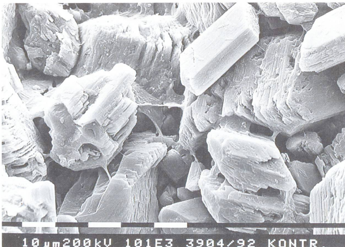
Korrodiertes Zementstein mit Gipskristallen; Vergrösserung etwa 1000mal.
