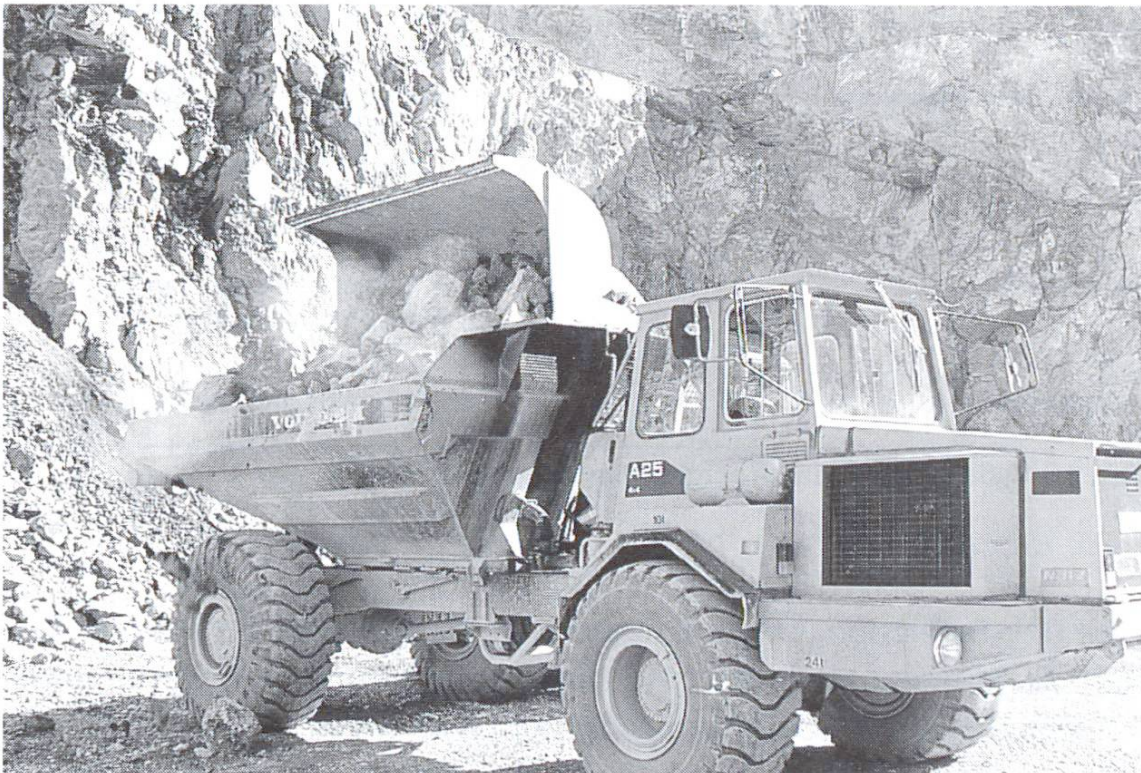
Muldenkipper zum Transport von Kalkstein.
