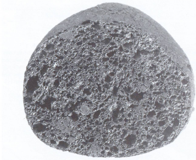
Schnitt durch ein Blähtonkorn (Durchmesser ca. 20 mm).
